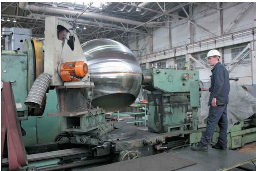
Обработка шаровой пробки на токарном станке
