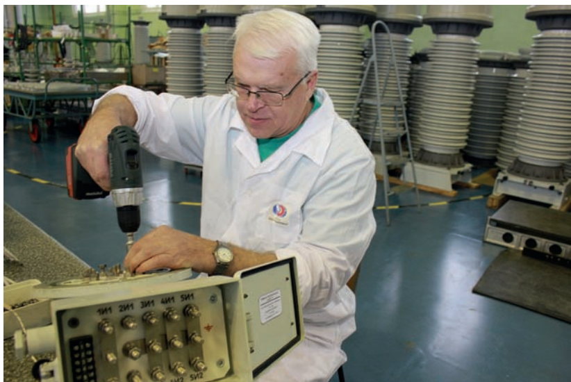
Сборка трансформаторов тока с элегазовой изоляцией
